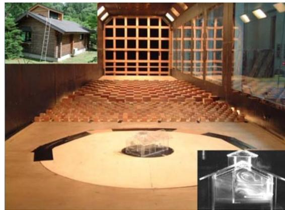
自然風を利用した建物の換気・通風予測手法である回流型風洞のしくみを学ぶとともに、建物壁面の風圧係数の測定の状態を見学します。また様々な実際の模型を見るとともに、橋梁の耐風設計のきっかけになったタコマ橋の崩落事故のビデオから、耐風設計の重要さを学びます。
